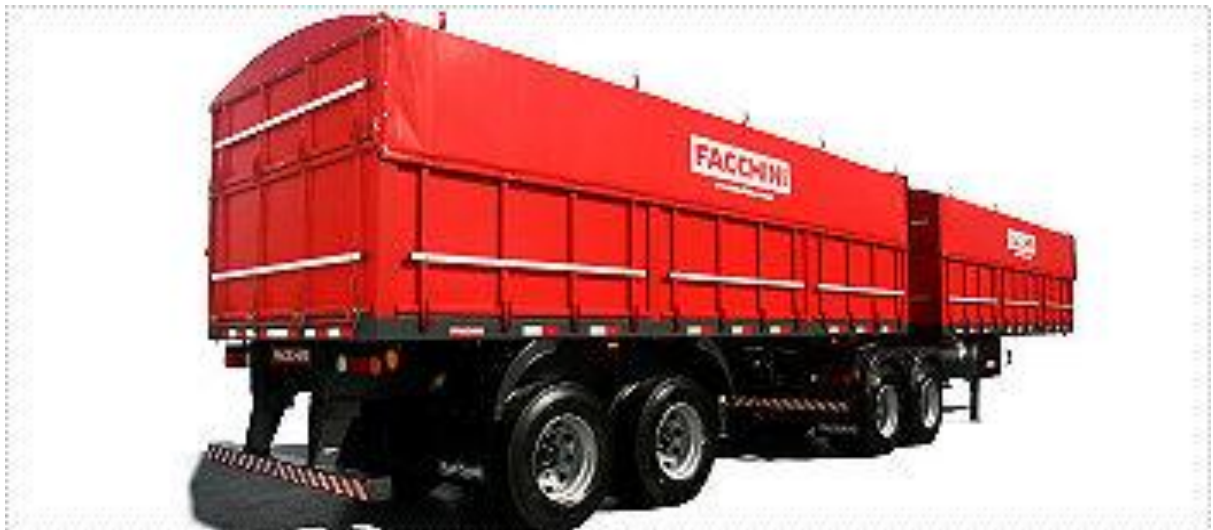
Figura 16 - Imagem de caminhão graneleiro com capacidade de carga de 40 a 45 toneladas de soja.
