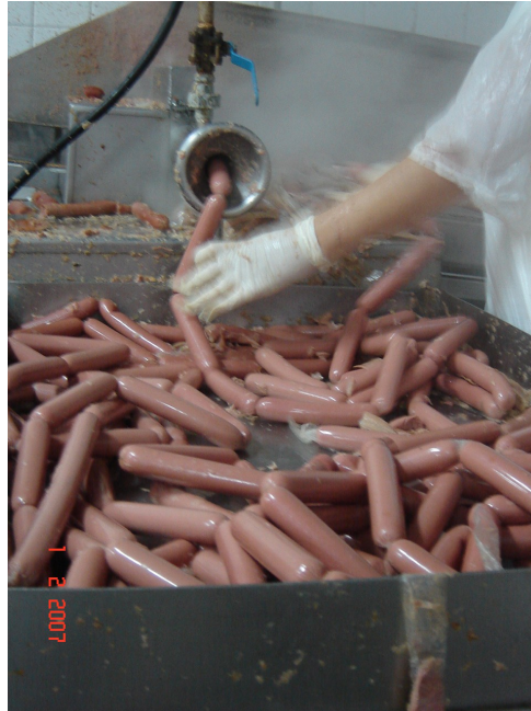
Figura 13: Foto ilustrativa do processo de descasque da salsicha
