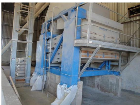
**Figura 11: Máquina de Pré-limpeza**
