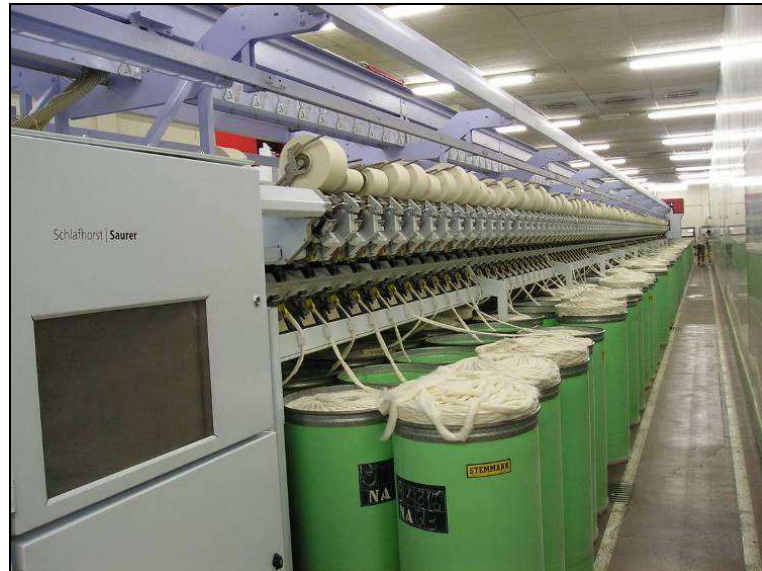
Figura 8: Open End (Fiação a rotor)
