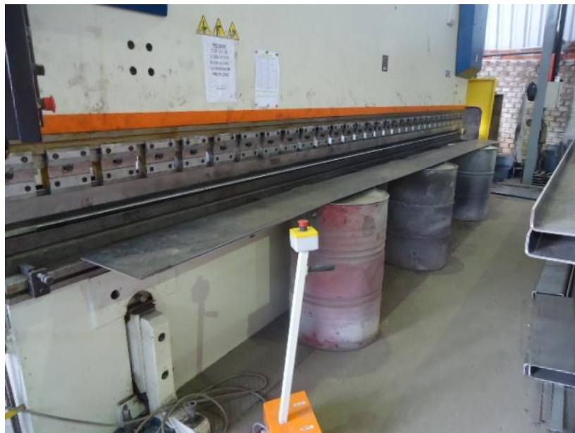
Figura 13 - Tambores improvisados para apoiar a peça.
