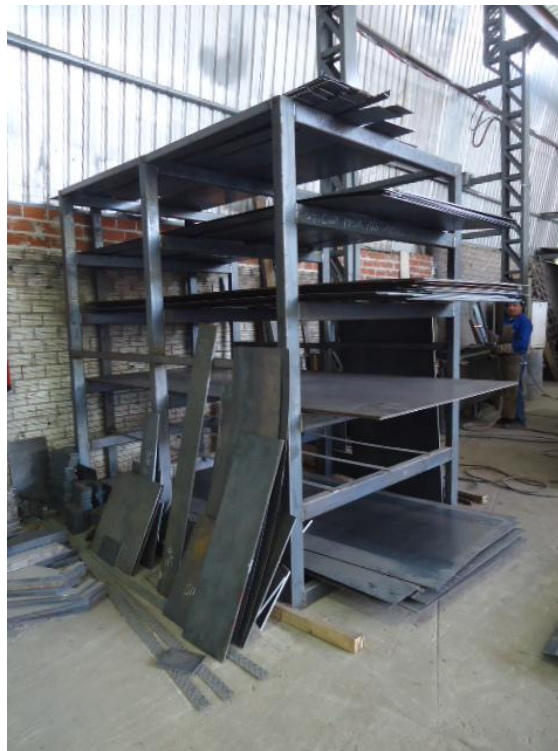
Figura 15 - Estaleiro de chapas de 3 metros
