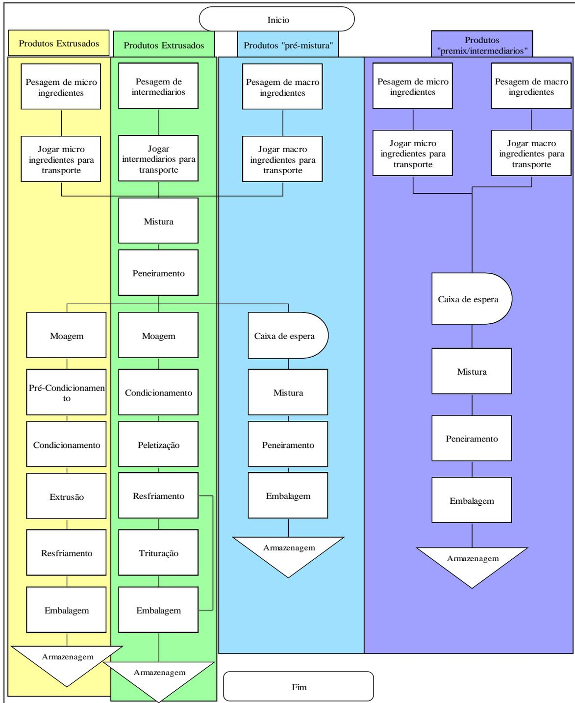
Figura 6 - Fluxograma dos processos da fábrica
