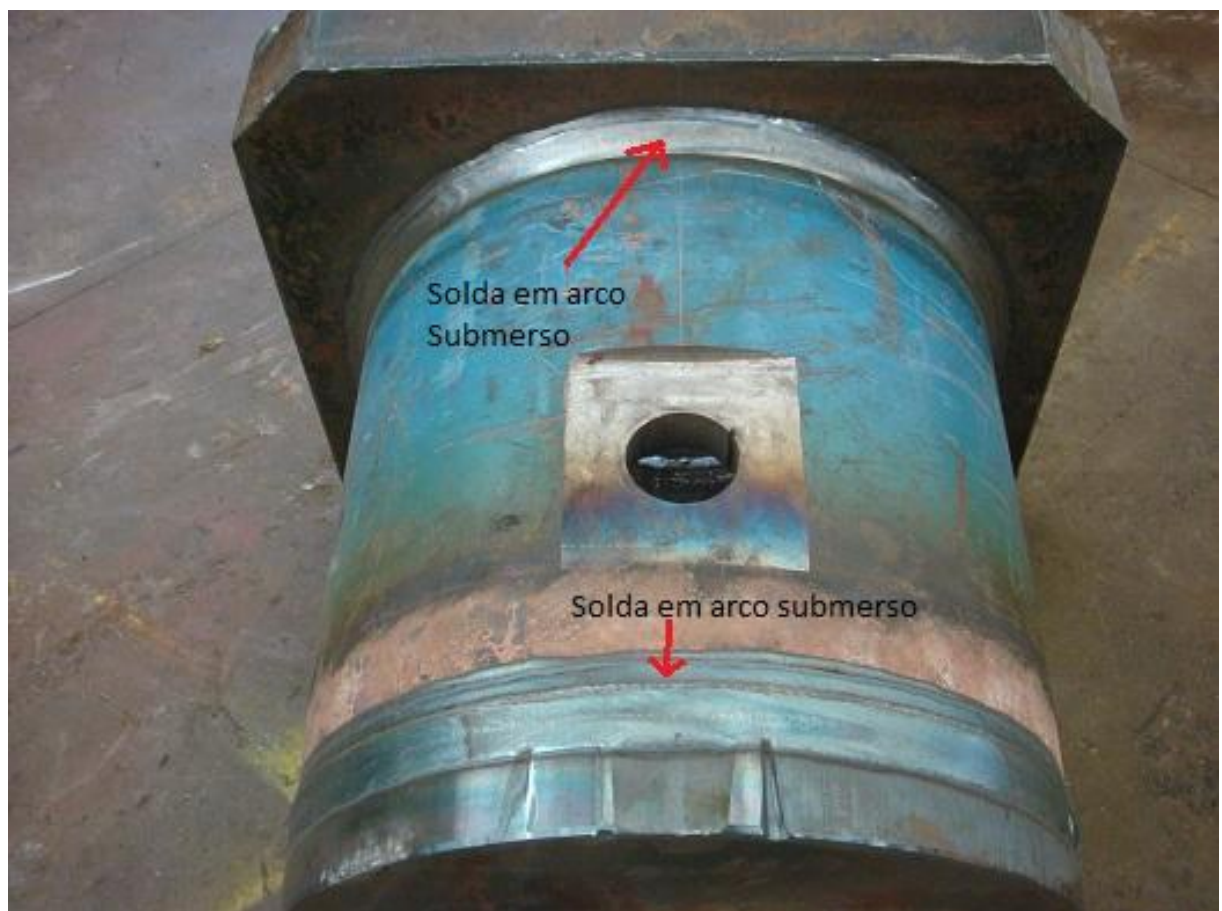
Figura 6 – Local de Solda com Arco Submerso
