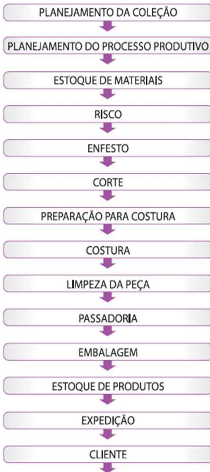
Figura 3: Etapas do Processo produtivo para Indústria de Confecção
