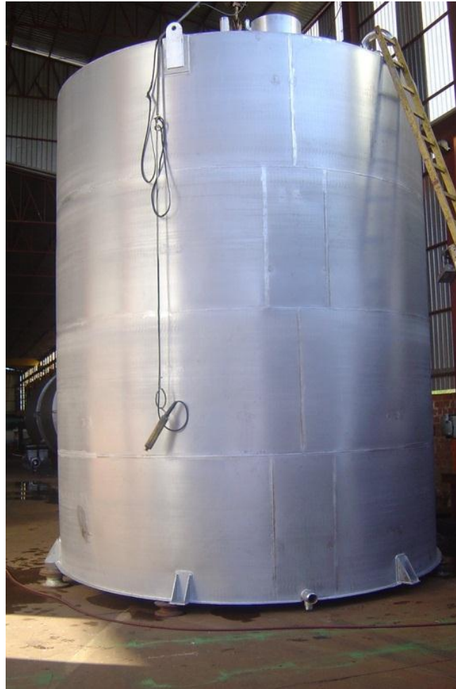
Figura22: Tanque 207 posicionado em pé
