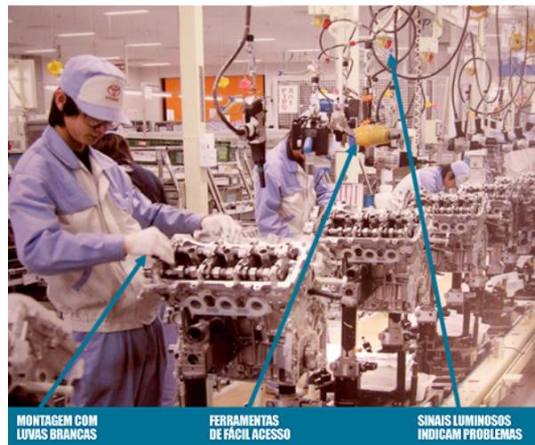
**Figura 1 - Linha de montagem com luvas brancas, sinais luminosos que indicam problemas e ferramentas mais utilizadas estrategicamente dispostas. Fonte - <http://totalqualitymanagement.wordpress.com>**
