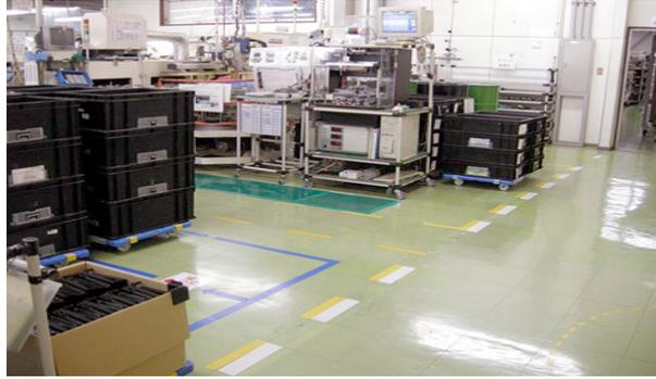
**Figura 3 - Piso demarcado com fitas adesivas coloridas. Cada cor tem uma função diferente. Tudo é disposto sobre estruturas com rodinhas. Fonte - <http://totalqualitymanagement.wordpress.com>**
