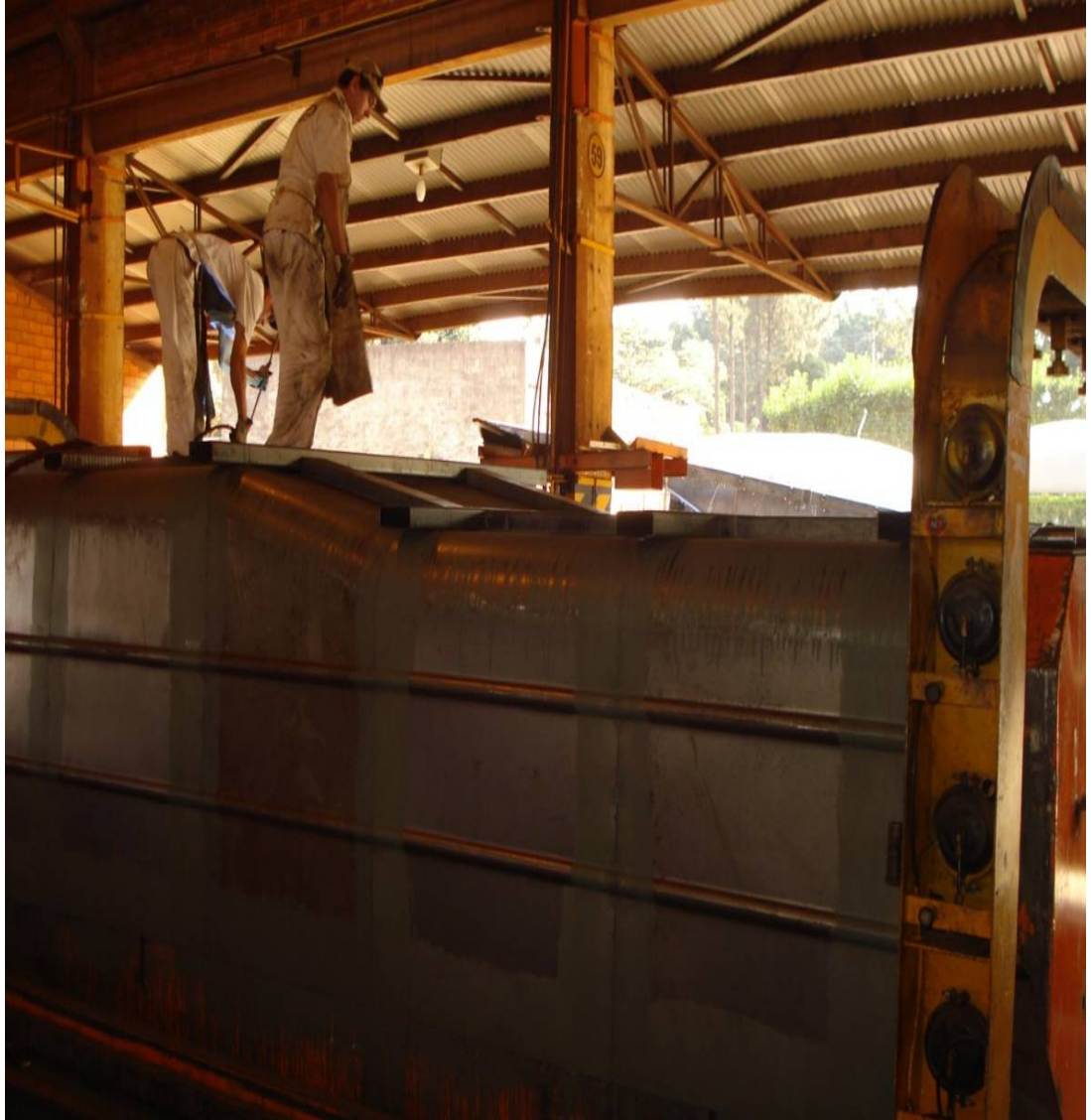
Figura 27: Foto montagem da peças dos implemento Semi Reboque Articulado Traseiro em cima do gabarito.
