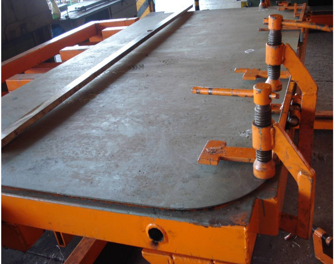
Figura 30: Foto montagem de uma Tampa do Semi Reboque basculante 25 m 3 .
