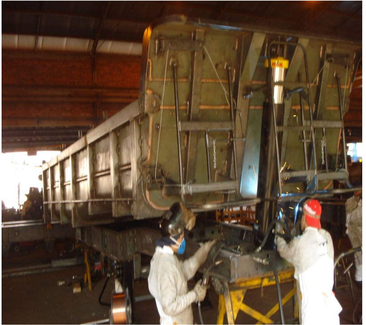
Figura 31: do processo de acoplamento implemento SRAB Traseiro
