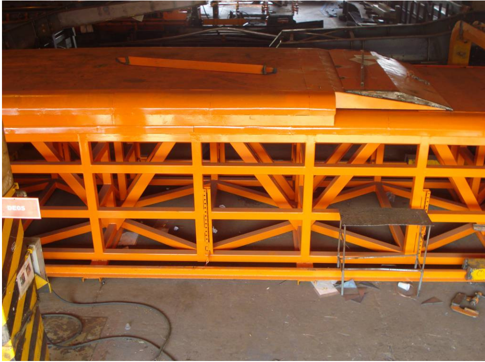
Figura 49: Foto Novo Gabarito de Caixa de Carga, instalado no mês de setembro.
