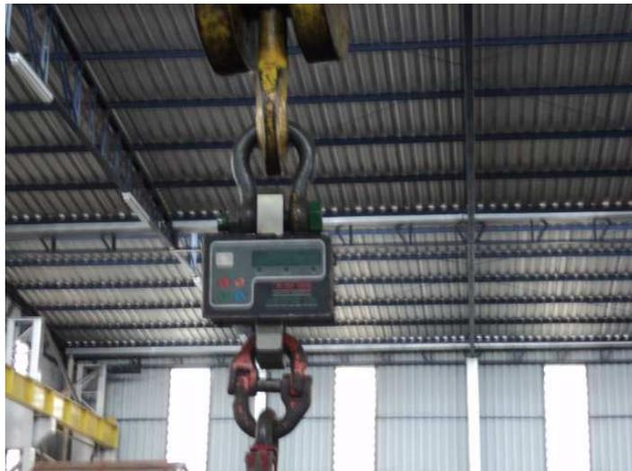
**Figura 20 - balança digital presa a ponte rolante**
