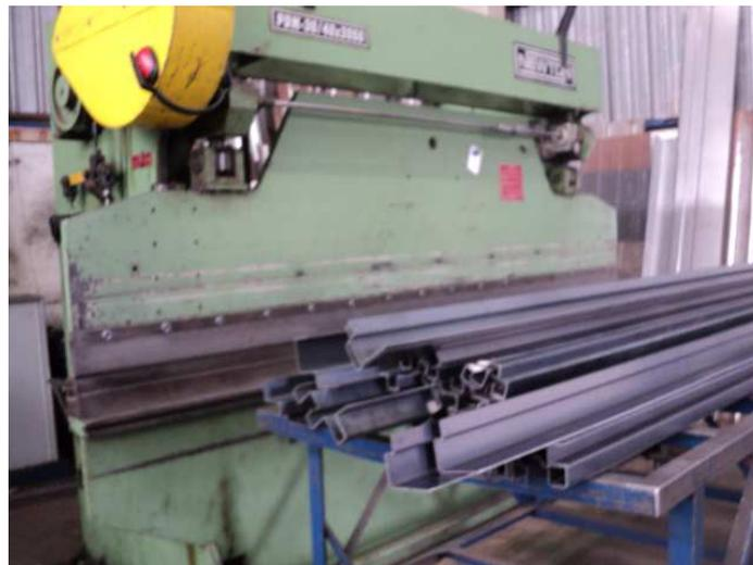
**Figura 17 - Prensa Dobradeira Mecânica de 3 metros**
