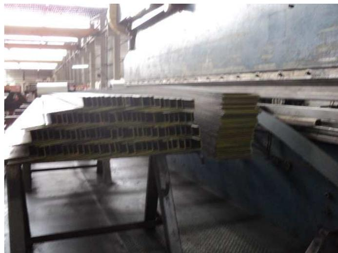
**Figura 18 - Peças em processamento na Prensa Dobradeira de 6 metros**
