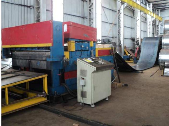
**Figura 12 – Desbobinadeira**
