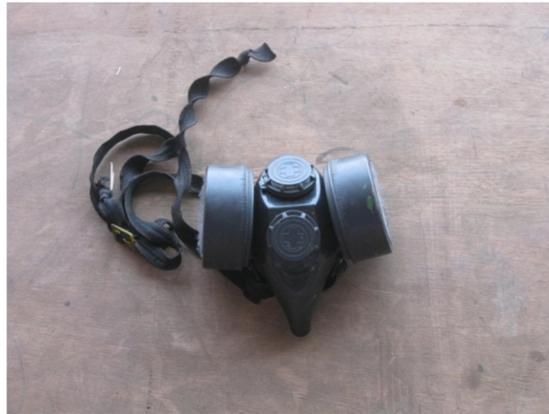
**Figura 5 – EPI - Protetor respiratório com filtro para fumos metálicos.**
