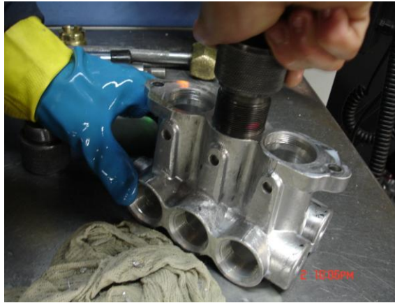
Figura 25: Teste de gabarito ( Poka-Yoke )
