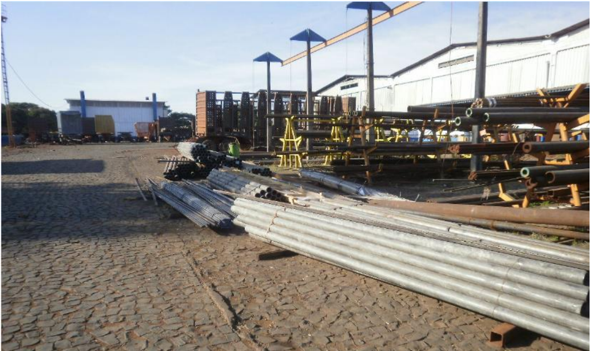
Figura 7 – Peças do setor de Usinagem deteriorando sem uma cobertura adequada
