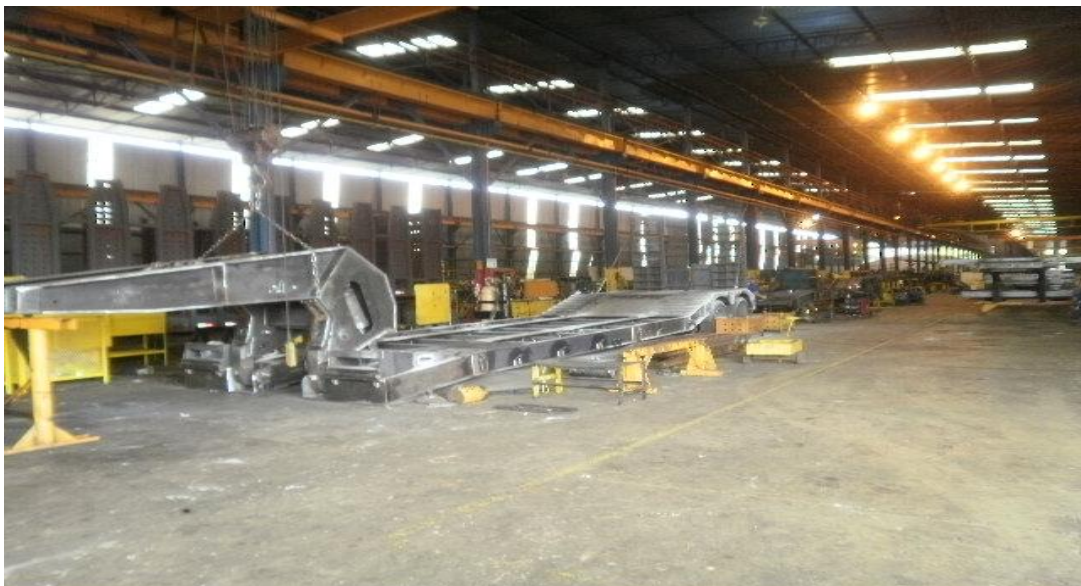
Figura 4 – Linha de montagem do Semi-Reboque Carrega-Tudo
