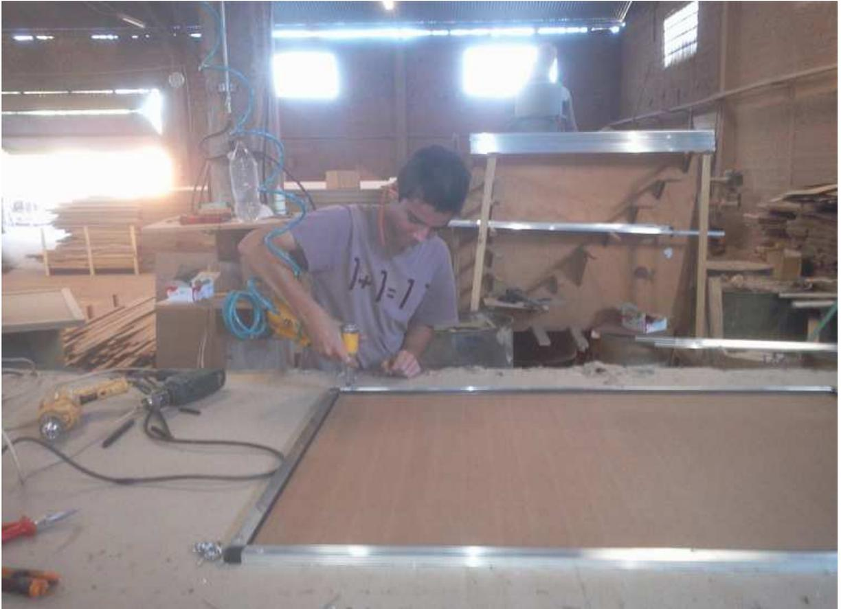
**Figura 7: Funcionário trabalhando sem nenhuma proteção no processo de montagem.**
