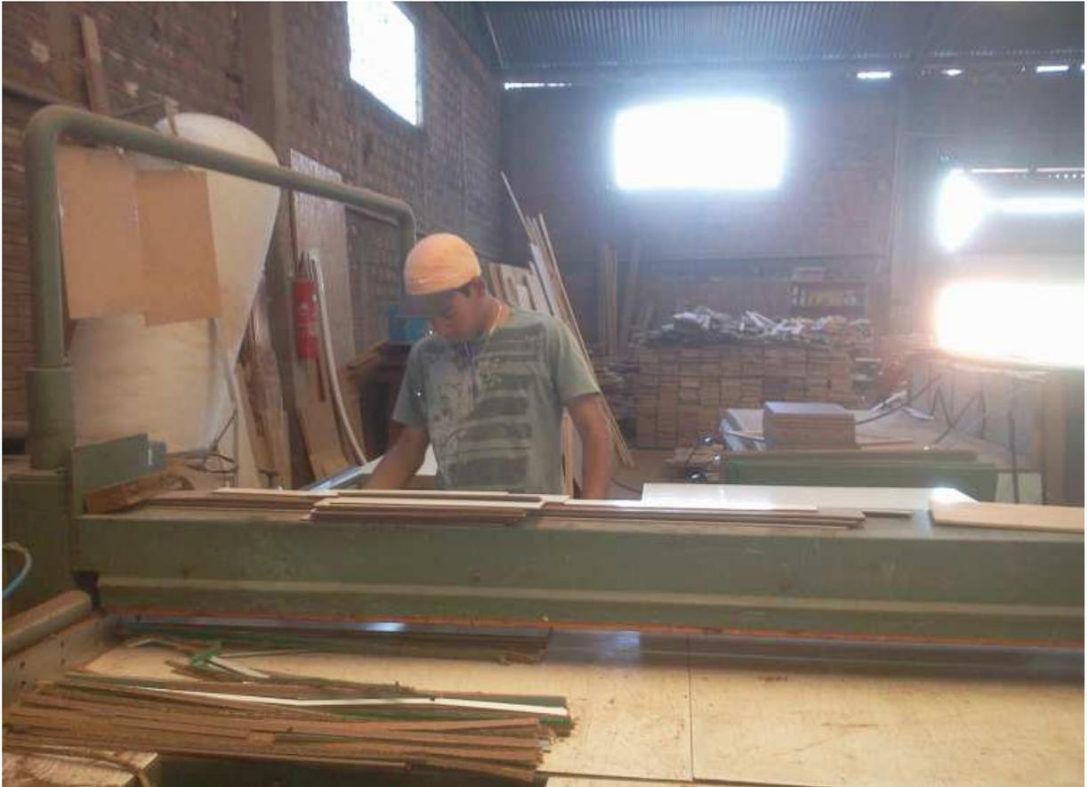
**Figura 6: Funcionário trabalhando sem nenhuma proteção no processo de corte de madeira.**
