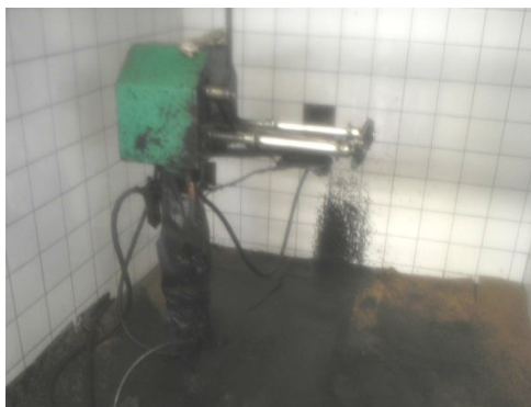
Figura 16: Aplicação de cola nas carcaças
