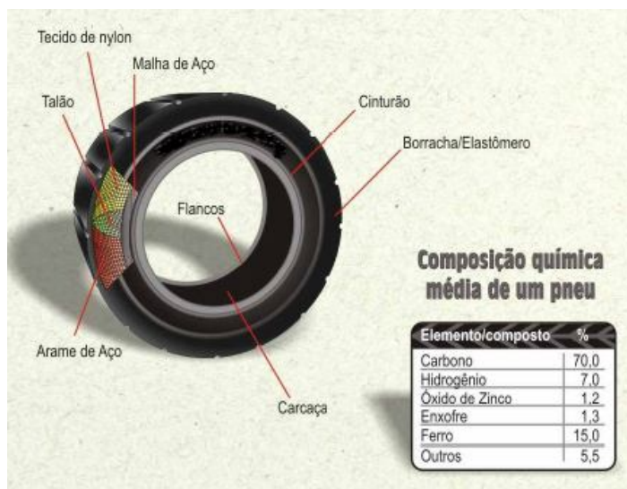
Figura 01: Estrutura do pneu
