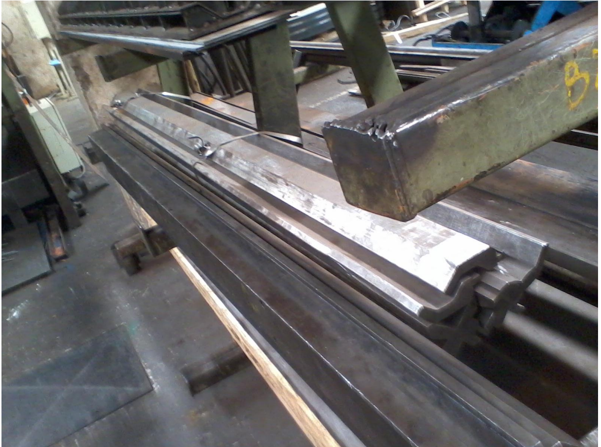
Figura 11: Ferramentas de dobra armazenadas.
