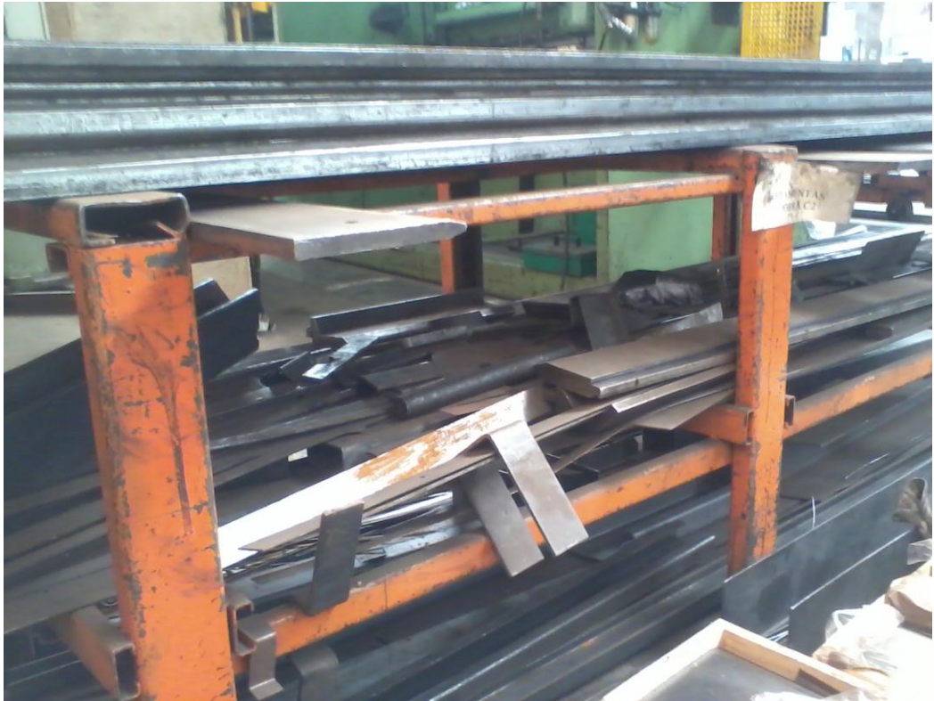
Figura 10: Ferramentas de dobra armazenadas.
