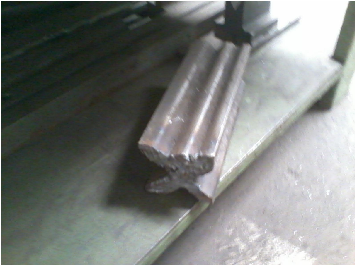
Figura 13: Ferramenta de dobra danificada.
