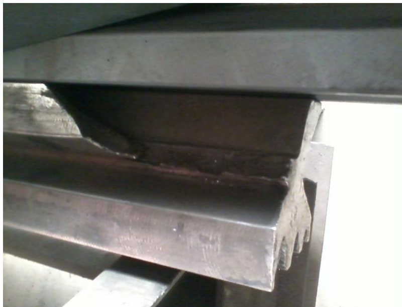
Figura 12: Ferramenta de dobra danificada.
