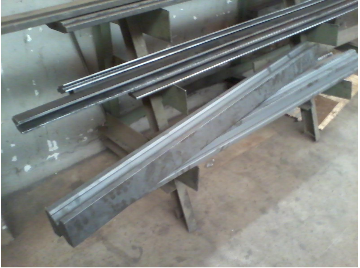
Figura 9: Ferramentas de dobra armazenadas.
