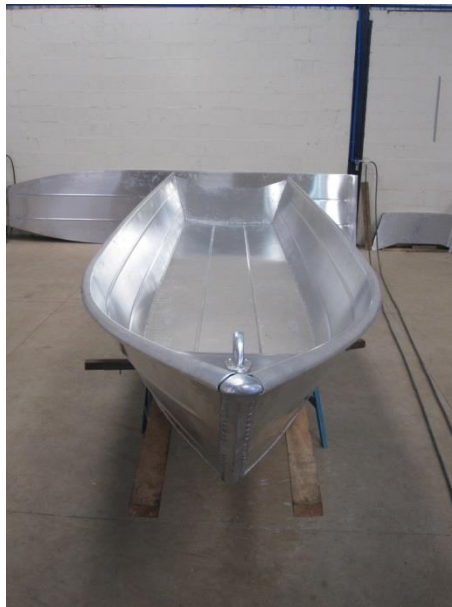
Figura 15 - Fixação do Castelinho de Proa
