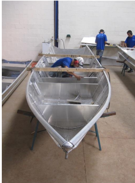
Figura 17 - Instalação das Laterais de banco, viveiro e Proa
