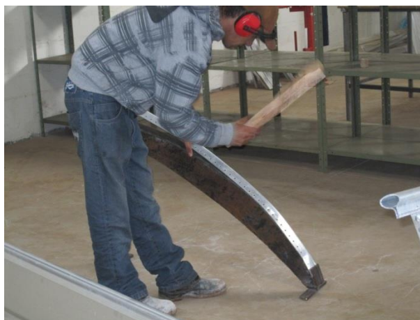
Figura 10 - Preparação da cantoneira de bico
