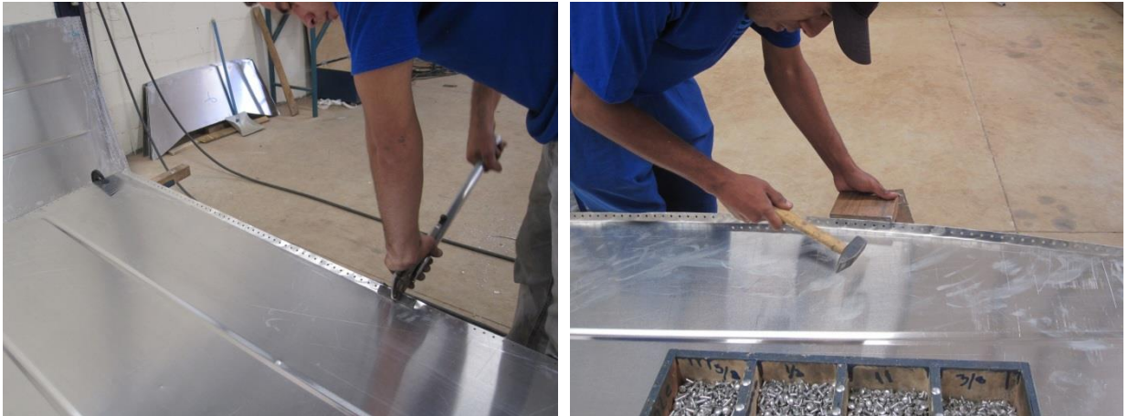
Figura 13 - Dobrando e alinhando Lateral do Casco
