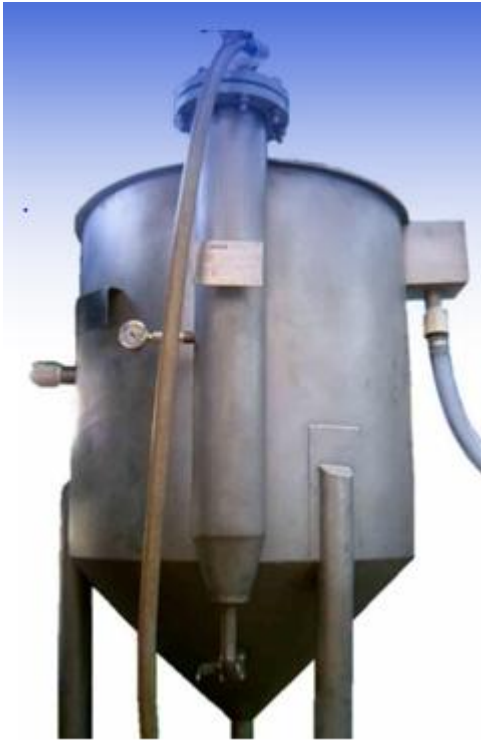
Figura 7: Flotador de ar dissolvido. Fonte: http://www.okte.com.br/Equipamentos/Flotador_FAD.htm
