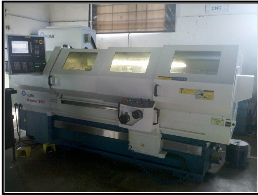
Figura 5 - Torno com comando numérico computadorizado (CNC)
