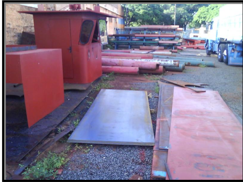
Figura 7 - Peças do setor de Usinagem deteriorando sem uma cobertura adequada
