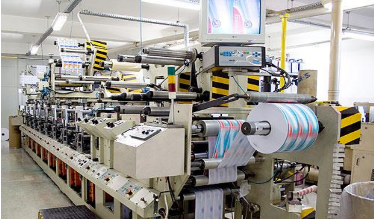
Figura 4: Impressora Modular – Base tinta UV.
