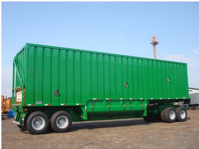
**Figura 2 - Reboque Canavieiro 4 Eixos**
