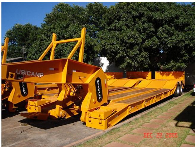
**Figura 3 - Semi-reboque Carrega Tudo 2 Eixos Pescoço Removível**
