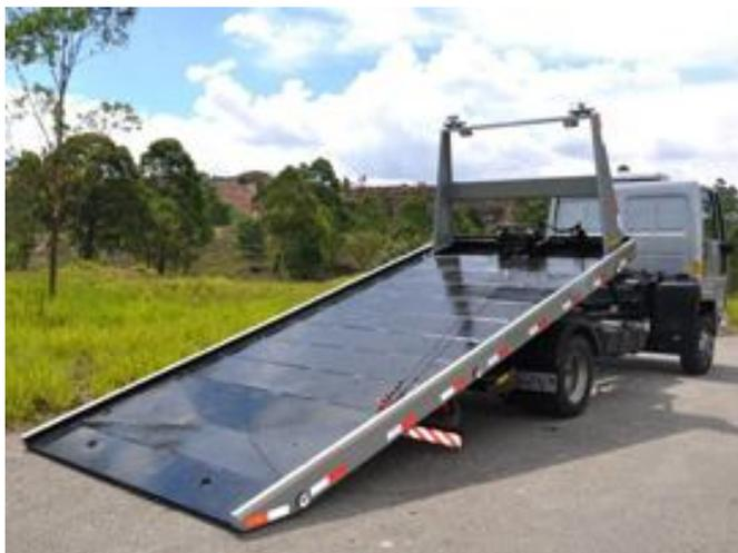
**Figura 7 - Plataforma Hidráulica Auto Socorro 10,0m**
