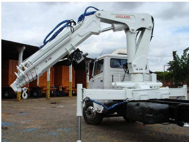
**Figura 5 - Guindaste Hidráulico AGR 35.000**
