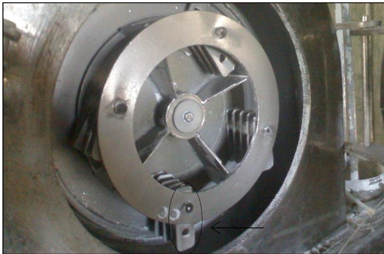
**Figura 5: Interior de um moinho de martelos, em destaque um martelo**
