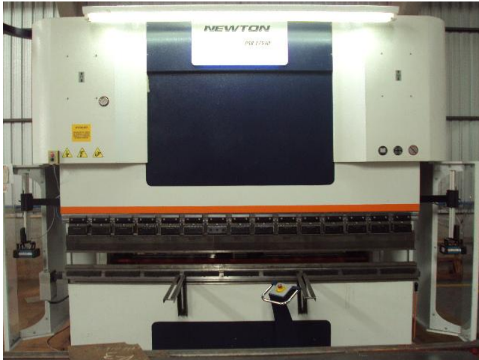
Figura AC. 2: Dobradeira Newton PSR 17530 CNC (Comando Numérico Computadorizado).
