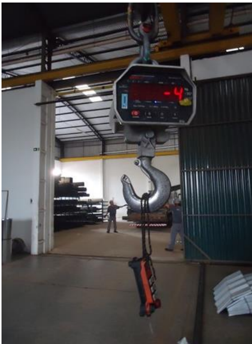
Figura 20: Controle da ponte pendurado.
