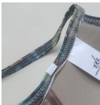
Figura 90 - Tecido Sobrando na Parte Interna da Peça. Fonte: Autor.
