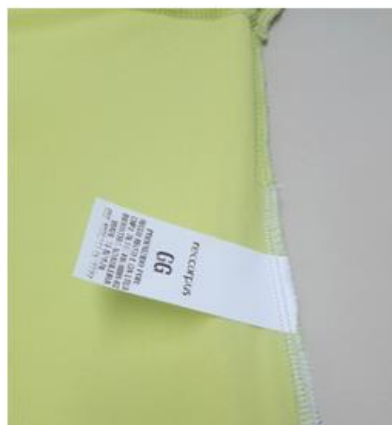
Figura 51 - Etiqueta Mal Posicionada. Fonte: Autor.
