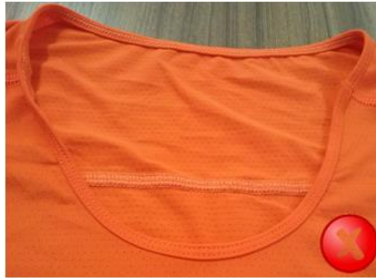
Figura 36 - Decote com a Costura Desbeçada. Fonte: Autor.
