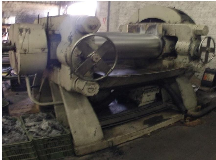
**Figura 17 - Cilindro compressor de borracha.**
