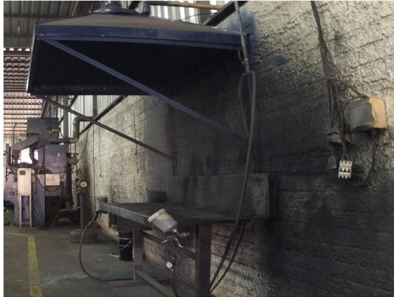
**Figura 21 - Bancada para revestimento e pinturas adesivas em partes de metal.**
