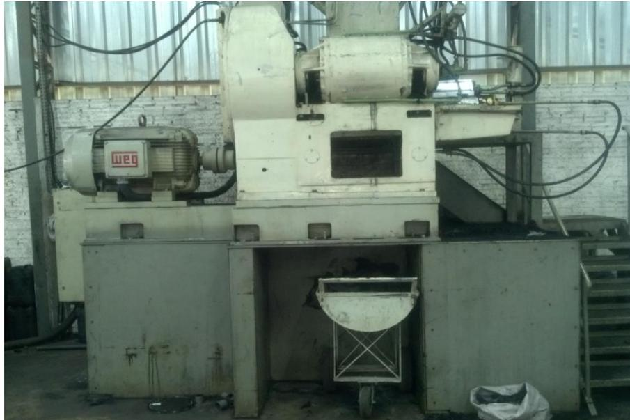
**Figura 16 - Máquina para mistura de borracha (Bambury).**
