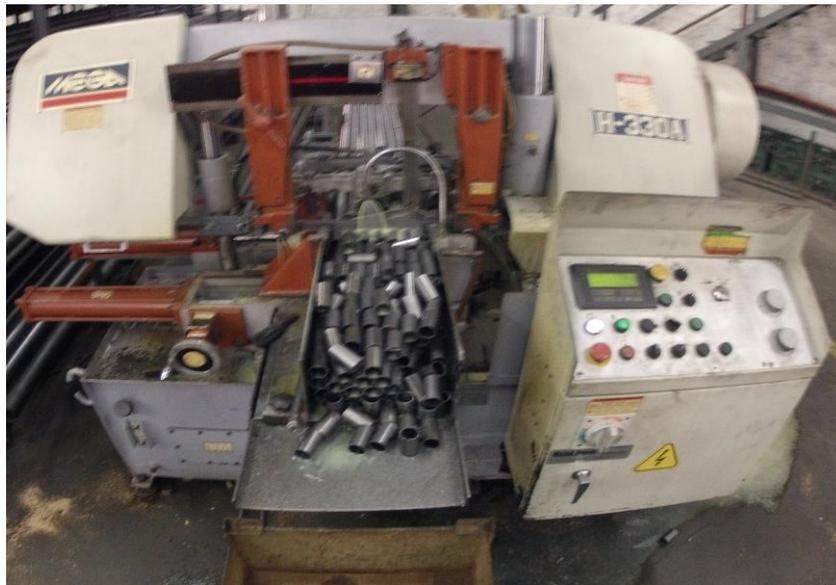
**Figura 19 - Máquina para corte de tubos (Serra-fita).**
