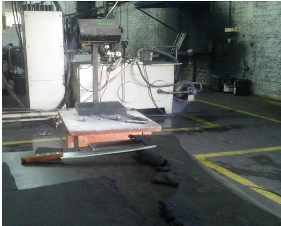
**Figura 18 - Bancada para corte e pesagem de borracha.**
