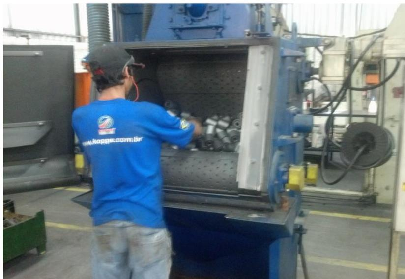
**Figura 20 - Máquina para jateamento de partes de metal.**
