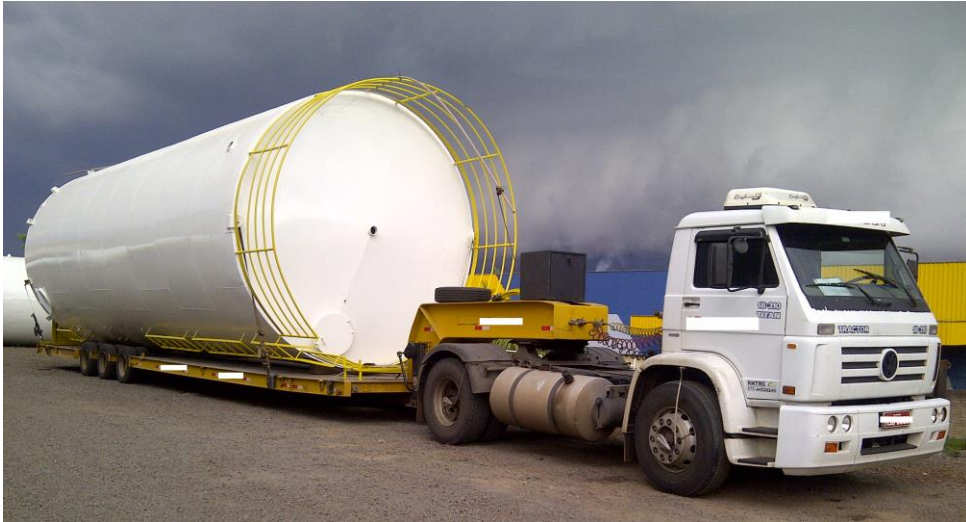
Figura 17 - Reservatório Tubular carregado em conjunto Trator-Rebaixada
