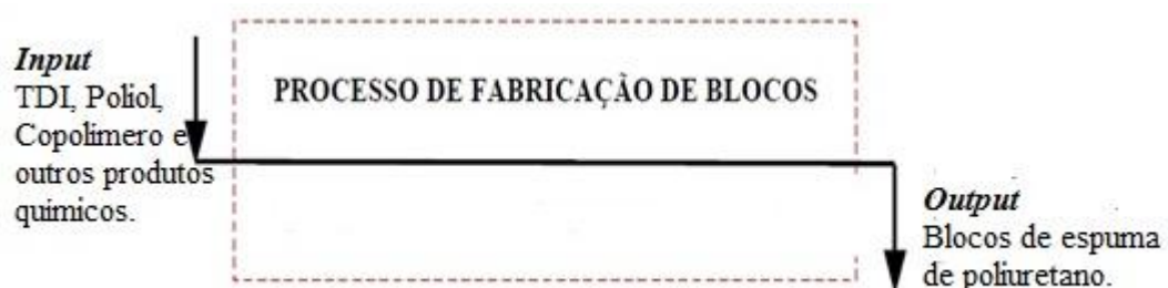
Figura 7: Processo de fabricação do bloco de espuma de poliuretano. Fonte: Autor (2014)
