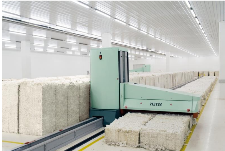
Figura 5: Abridor automático de fibras. Fonte: Rieter (2014)
