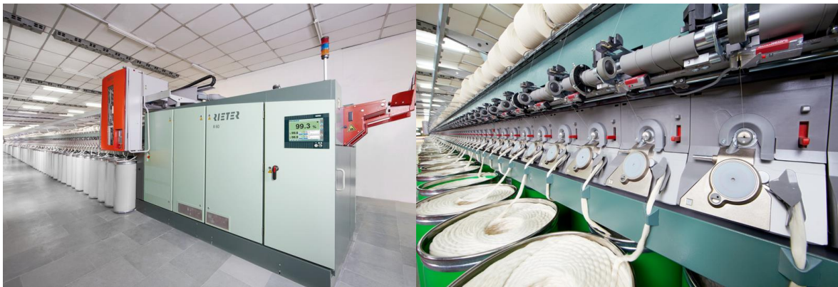
Figura 15: Filatório Open-end. Fonte: Rieter (2014)
