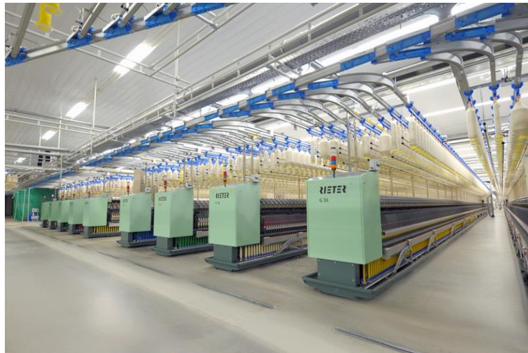
Figura 12: Filatório Anel. Fonte: Rieter (2014)
