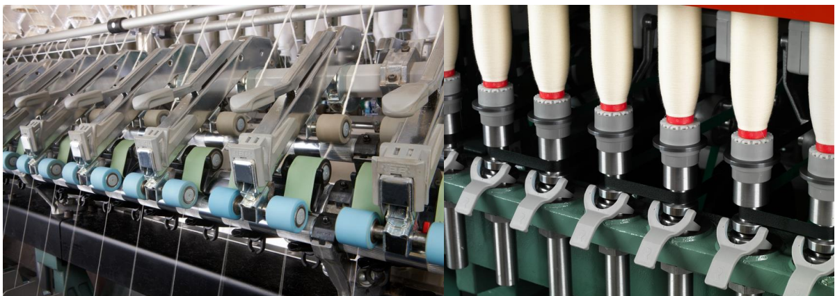
Figura 13: Trem de Estiragem e Espulas. Fonte: Rieter (2014)
