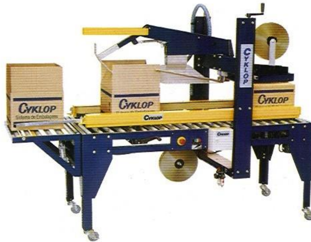
Figura 17: Máquina automática para lacração/fechamento de caixas de papelão. Fonte: CD Embalagens (2014)
