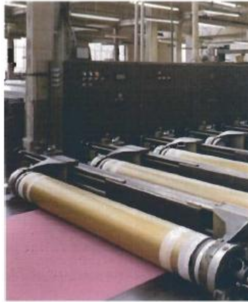
Figura 15: Aspecto de uma Máquina de Estampar ao Quadro Rotativo Fonte: Neves (2000, p. 27)
