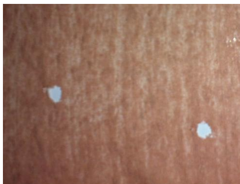
Figura 10: Buraco no Tecido
