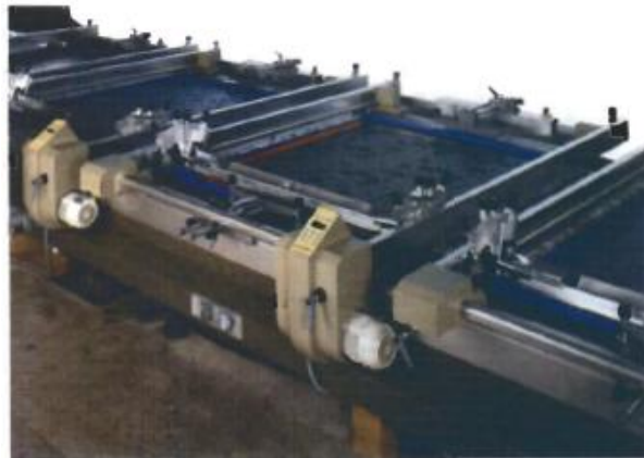
Figura 14: Aspecto de uma Máquina de Estampar ao Quadro Plano Fonte: Neves (2000, p. 26)
