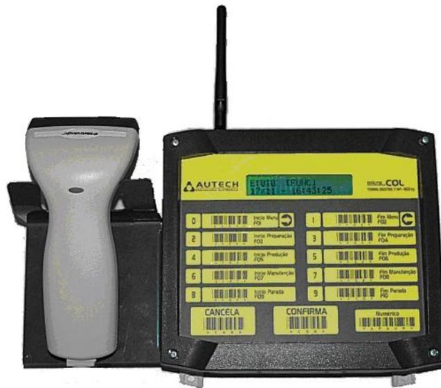
**Figura 8 - Terminal fixo para coleta de dados**
