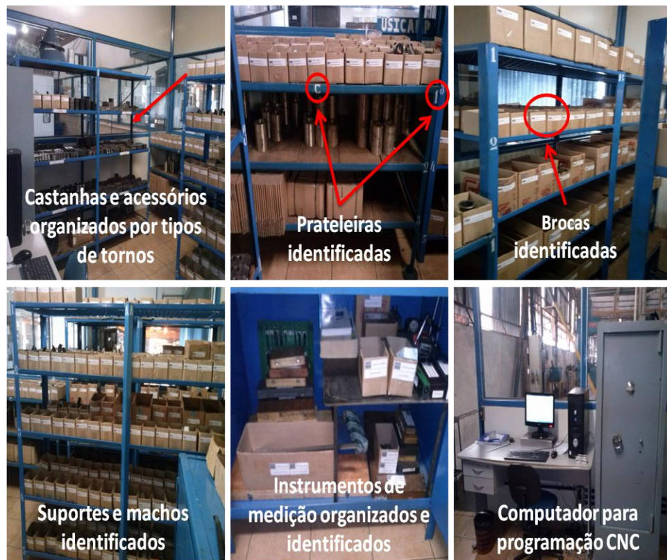
Figura 12: Organização e identificação das ferramentas da célula CNC
