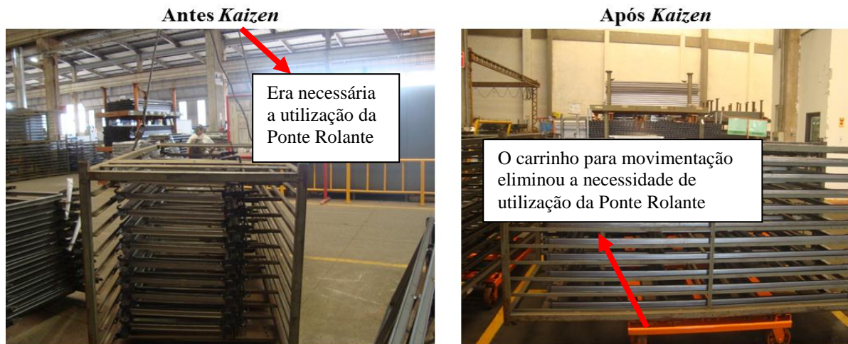
Figura 33 – Comparação entre os métodos para movimentação dos racks antes e após o Kaizen
