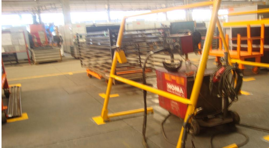
Figura 27 – Cavalete para preparação das ferragens após a operação de solda
