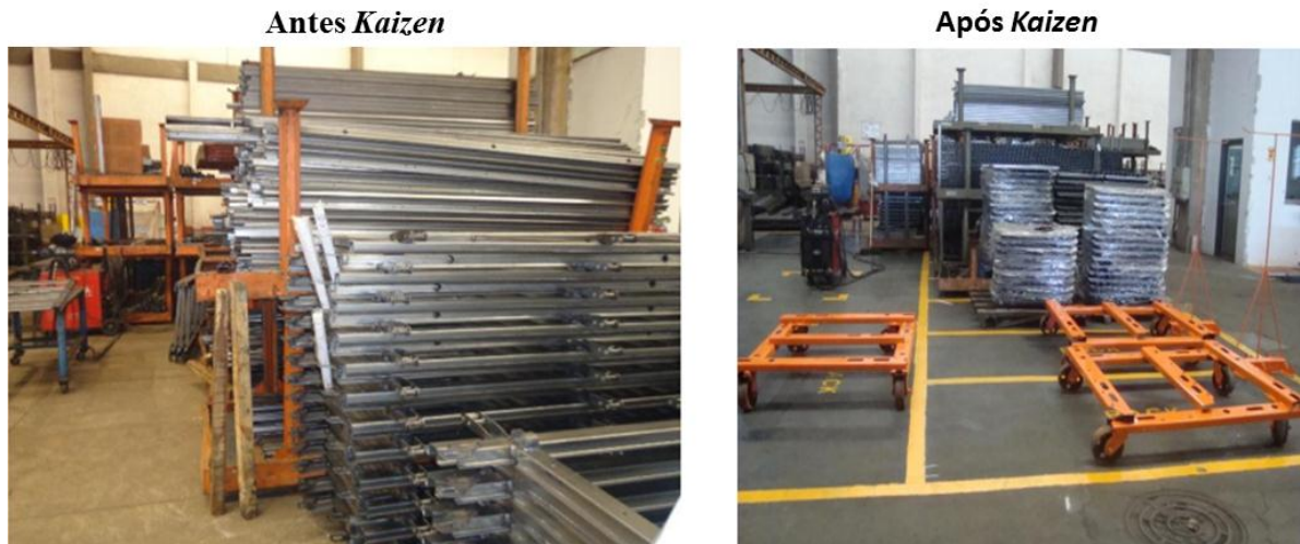
Figura 36 - Área do setor antes e após a aplicação do 5S
