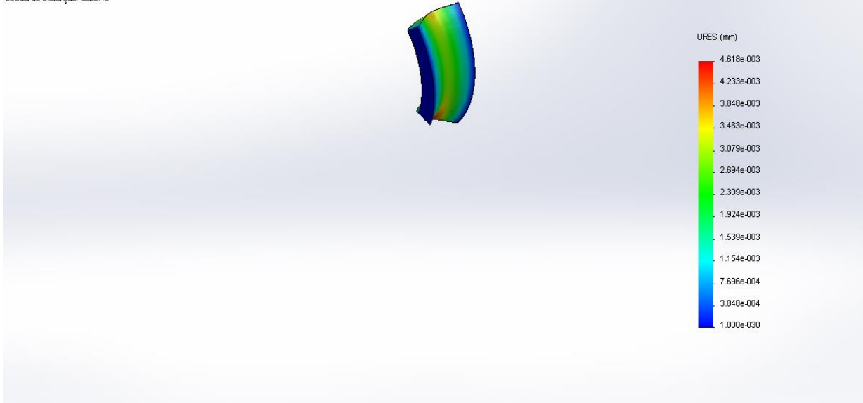
Figura 14 - FEA da Palheta da Bomba de Dragagem 3D Fonte: Autor
