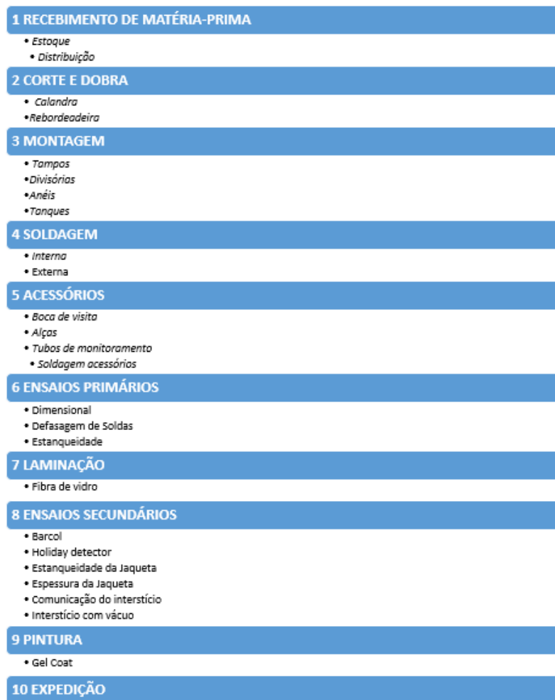
Figura 6: Fluxograma produtivo dos tanques jaquetados
