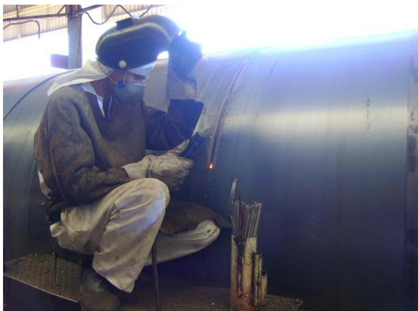
**Figura 24: Processo de Solda Externa**
