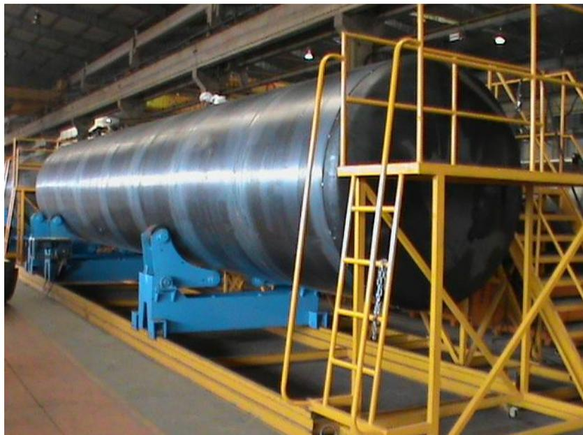
**Figura 17: Processo Solda Externa**
