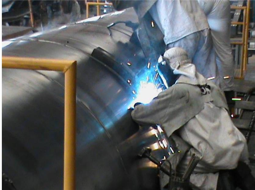
**Figura 35: Novo Processo de Soldagem (MIG/MAG)**
