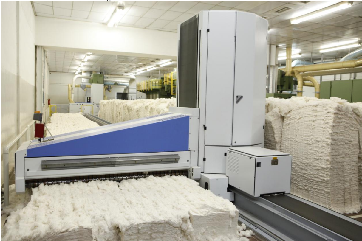
Figura 13 - Sala de abertura da indústria de fios
