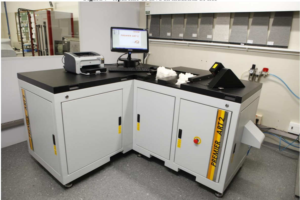
Figura 7 - Aparelho de HVI da indústria de fios
