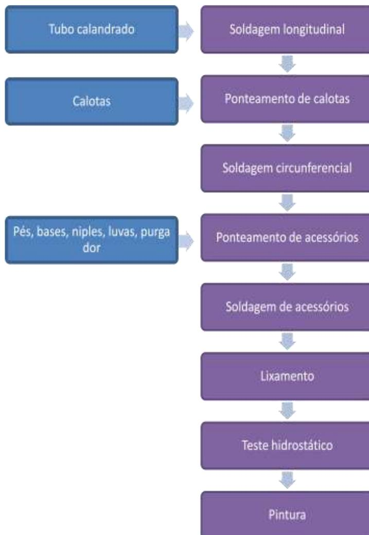
Figura 10: Processos e componentes para produção do reservatório
