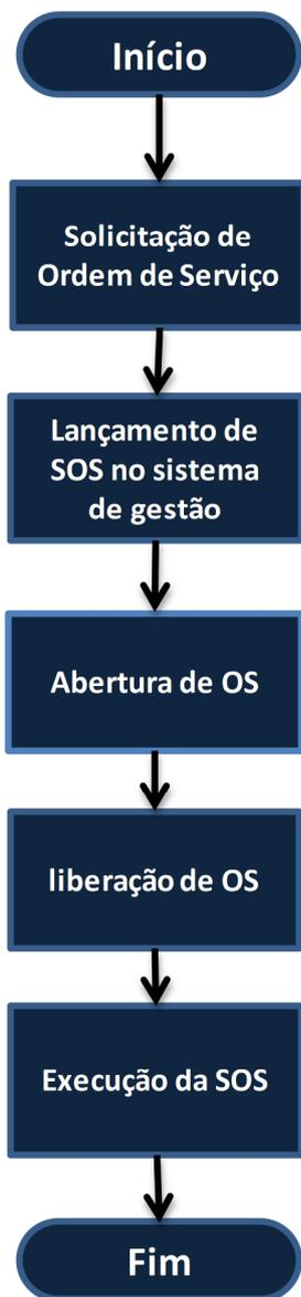
Figura 10 - Procedimento de Manutenção
