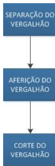
Figura 13: Processo de corte do vergalhão
