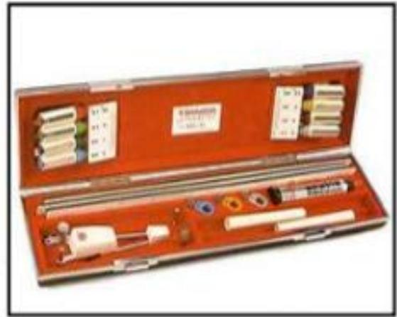
Figura-06: Estojo de normógrafo
