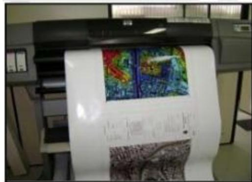
Figura-08: Ploter para desenho técnico
