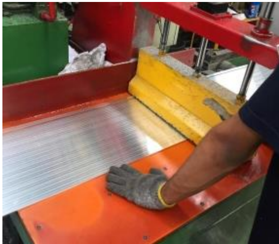
Figura 11 – Perfil alinhado a serra circular, para corte
