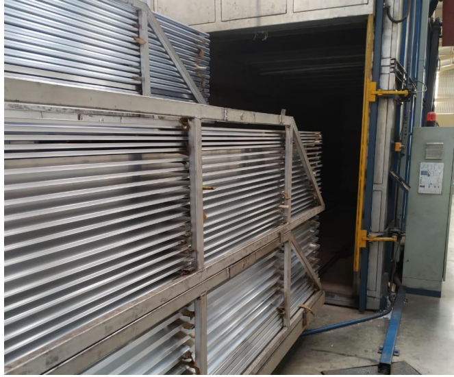
Figura 12 – Cestos alinhados ao forno para tratamento térmico
