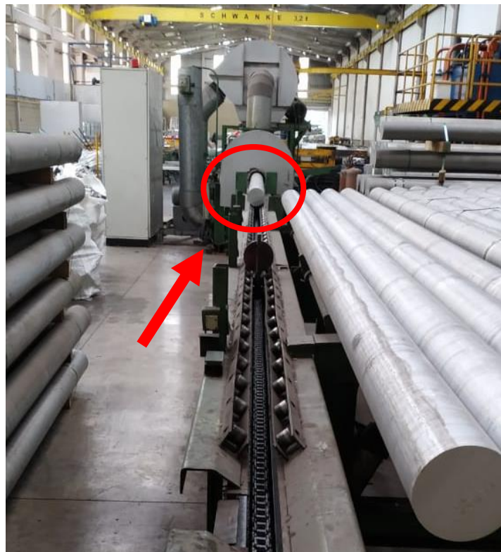
Figura 6 – Tarugo alinhado para ir ao forno
