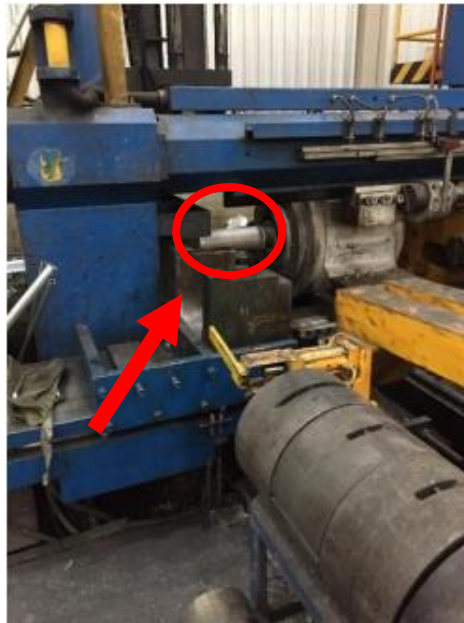
Figura 8 – Tarugo cortado e alinhado à prensa
