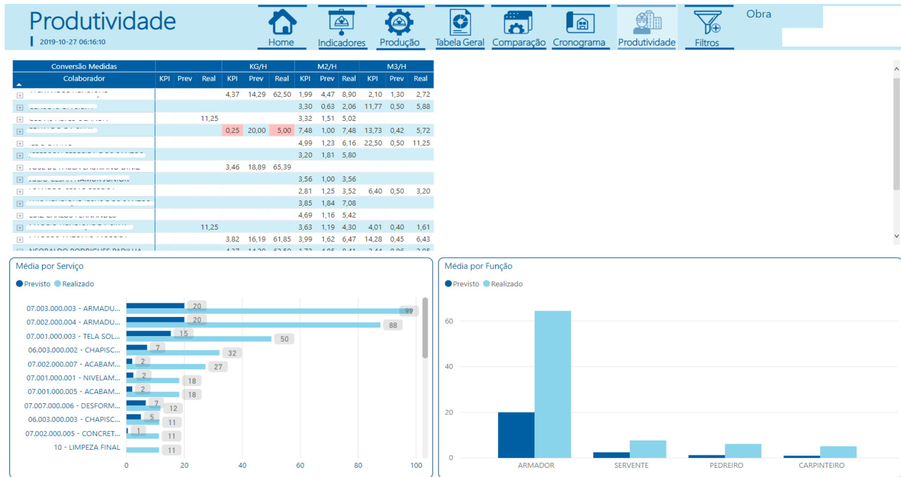
Figura 5: Funcionalidade de análise da produtividade e desvio (vermelho) da mão de obra.
