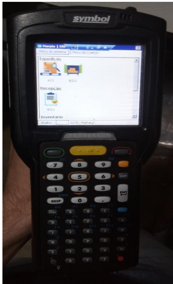
Figura 6 – Coletor usado para realizar leitura do código de barra.
