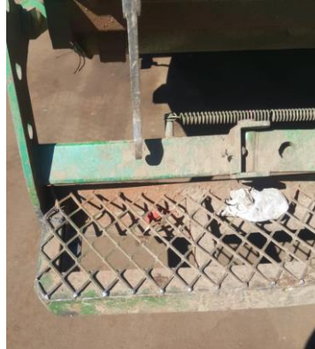
Figura 4: Soleira Montada por grades.
