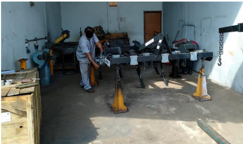
Figura 9 – Funcionário realizando montagem do implemento
