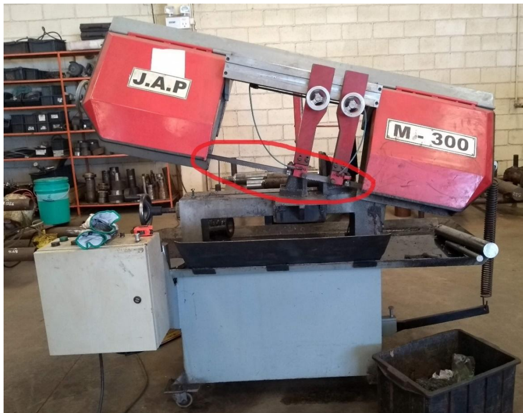
Figura 13: Máquina de corte - Destaque para a falta de proteção na fita de corte
