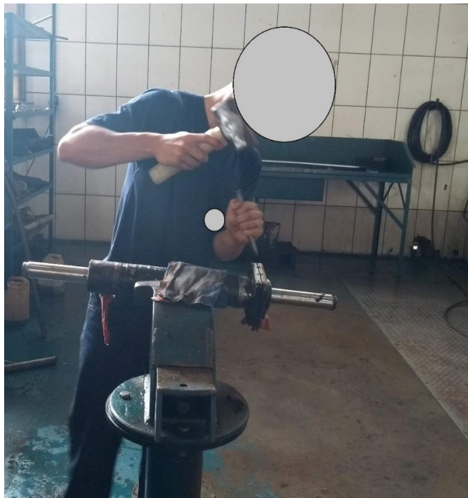
Figura 16: Colaborador realizando a desmontagem de um pistão hidráulico
