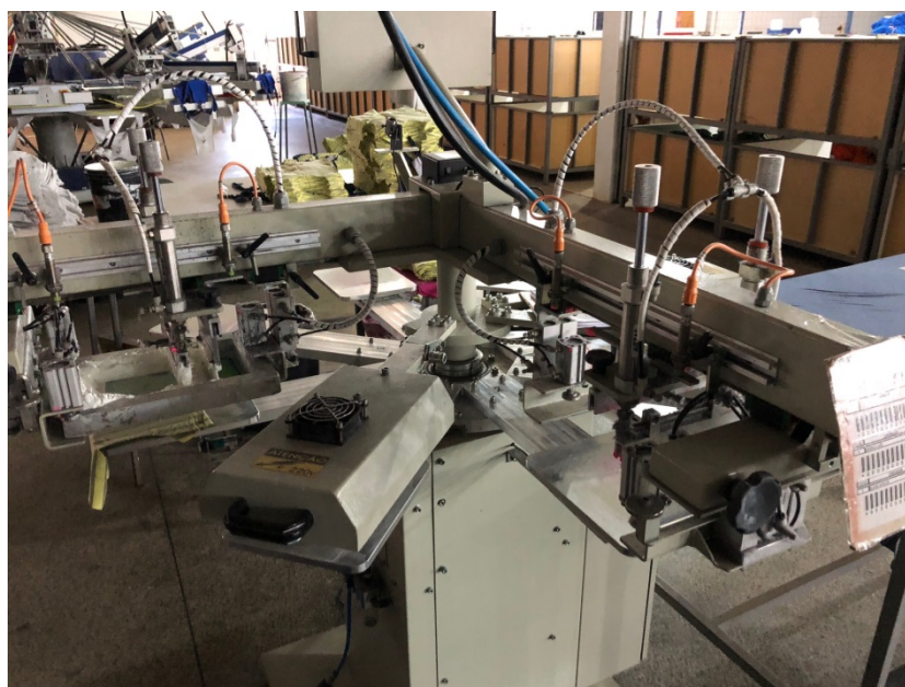
Figura 4 – Mini máquina rotativa para fazer silk pé de gola ou pequenas estampas.
