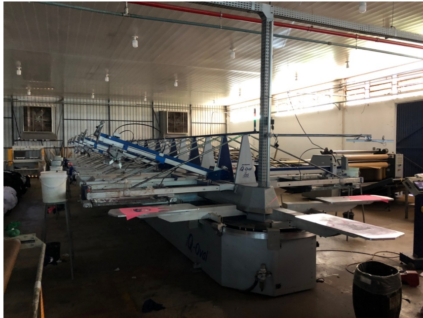
Figura 5 – Máquina Rotativa Oval ideal para uso de telão silk total estampa até 12 cores
